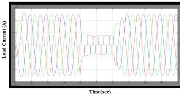
Fig.11. Load current due to non linear load
