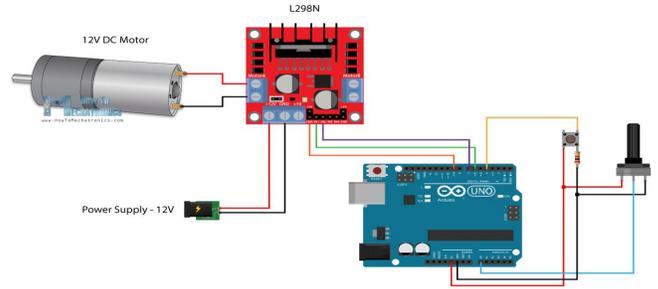
**Fig:L298D MOTOR DRIVE CONNECTION TO ARDUINO**
