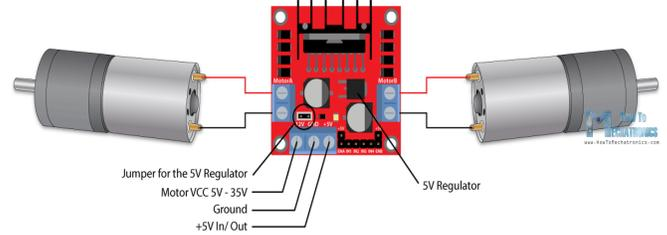
**Fig:L298D MOTOR DRIVE input or output**
