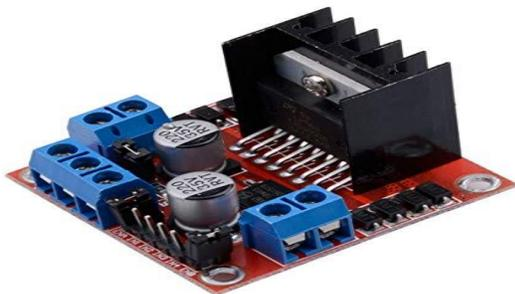
**Fig:L298D MOTOR DRIVE**
