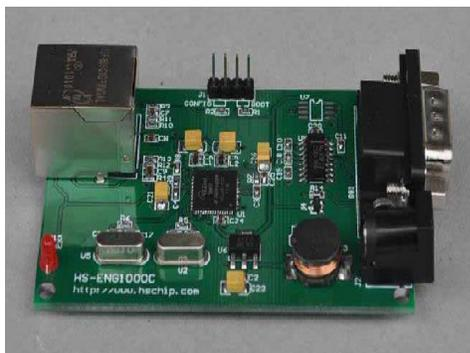
Fig. 3: Ethernet module
